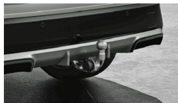
Anhängerkupplung mit schwenkbarem Kugelkopf
